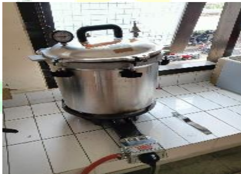
Gambar 6. Sterilisasi alat penelitian menggunakan autoklaf
