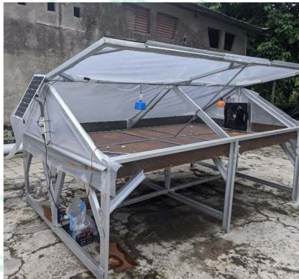
Solar Dome Dryer yang sudah selesai dan siap digunakan
