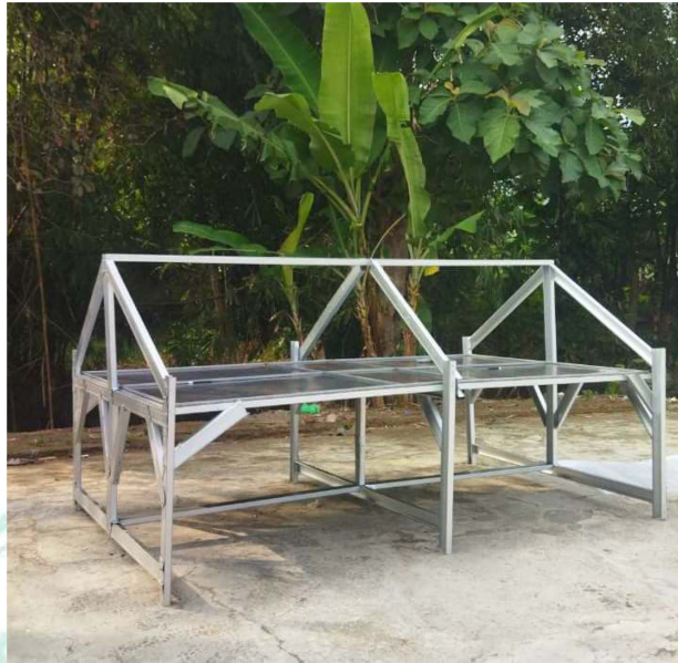
Rangka Solar Dome Dryer sebelum dipasangkan peralatan elektronik
