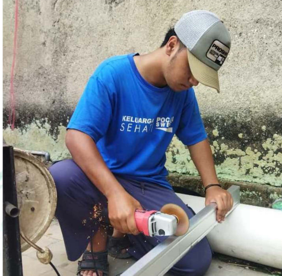
Pemotongan baja ringan untuk membuat rangka Solar Dome Dryer
