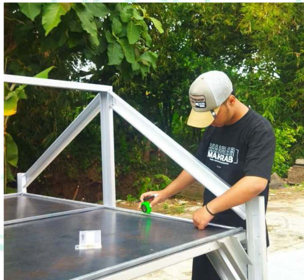
Pengukuran rak Solar Dome Dryer
